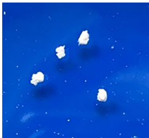
Рис. 6. Изображение флокул каолина, полученных в системе с ПА (двукратное увеличение)
