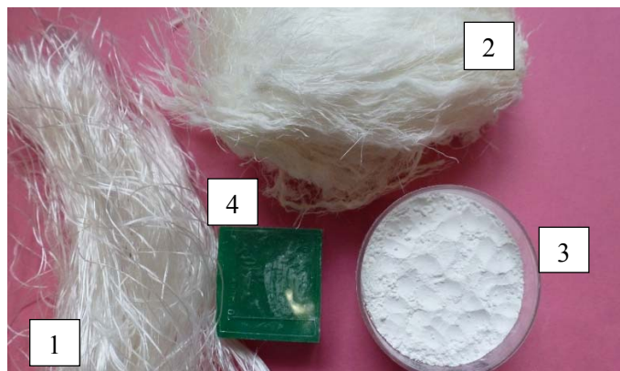
Рис. 1. Исходные гидратцеллюлозные волокна – 1, волокна \text{Al}_2\text{O}_3 – 2, нанопорошок – 3, порошок, нанесенный на подложку – 4
