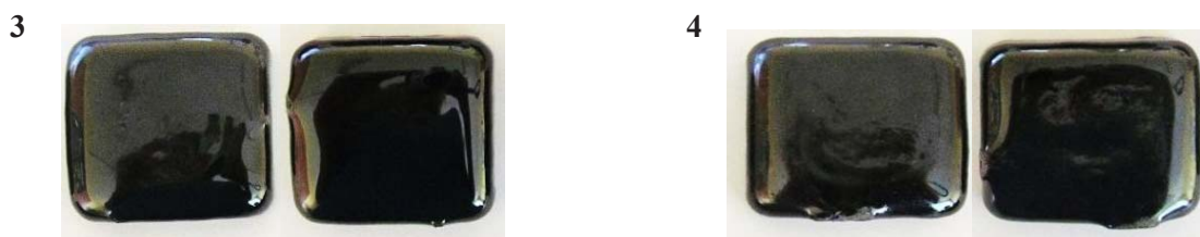
Образцы стекла Д1, синтезированного на основе диабаз с добавкой кальцинированной соды (3) и образцы стекла ДХ, полученного на основе диабаз с добавкой стимулятора кристаллизации – \text{Cr}_2\text{O}_3 (4)
