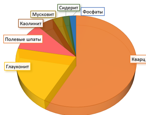
Рис. 2. Диаграмма количественного распределения минеральных составляющих глауконитсодержащих вскрышных пород Новодворского месторождения
