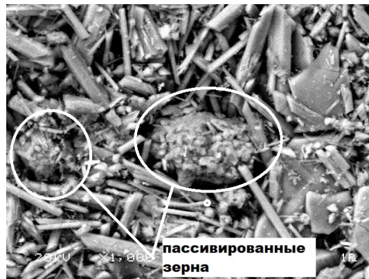
Рис. 3. Микрофотография образцов осадков, полученных при сернокислотном разложении фосфорита марки К-10 (увеличение \times 1\,000 , концентрация кислоты 45 %)
