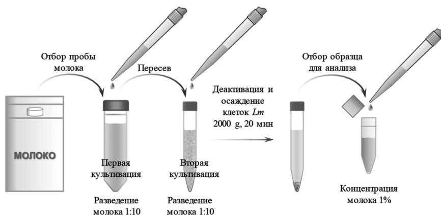
Рис. 4. Схема пробоподготовки, предшествующей обнаружению LM в молоке методом конкурентного ИФА
